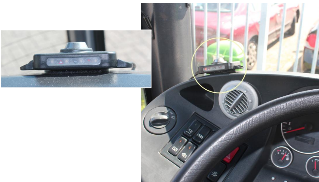
Figuur 4.1 De interface van de RijWijzer in de bus (links) en de locatie op het dashboard (rechts)
